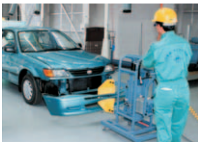
Проучване на възможностите за разкомплектуване на бъншните компоненти
